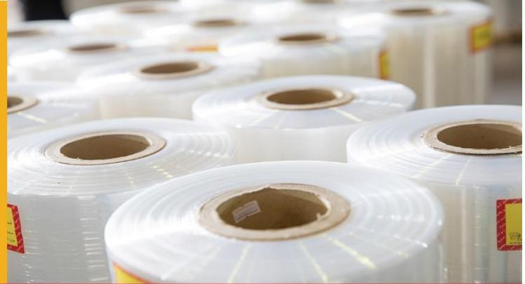
فیلم های استرج تولیدی شرکت آریوپلاست شیراز به روش کاست تولید شده و به دلیل بهره گیری از پرسنل ماهر در بخش تولید و استفاده از ماشین آلات چند لایه مدرن و امکان اضافه نمودن افزودنی های مختلف در لایه های گوناگون، از شفافیت و خواص فیزیکی بسیار عالی برخوردار است.
